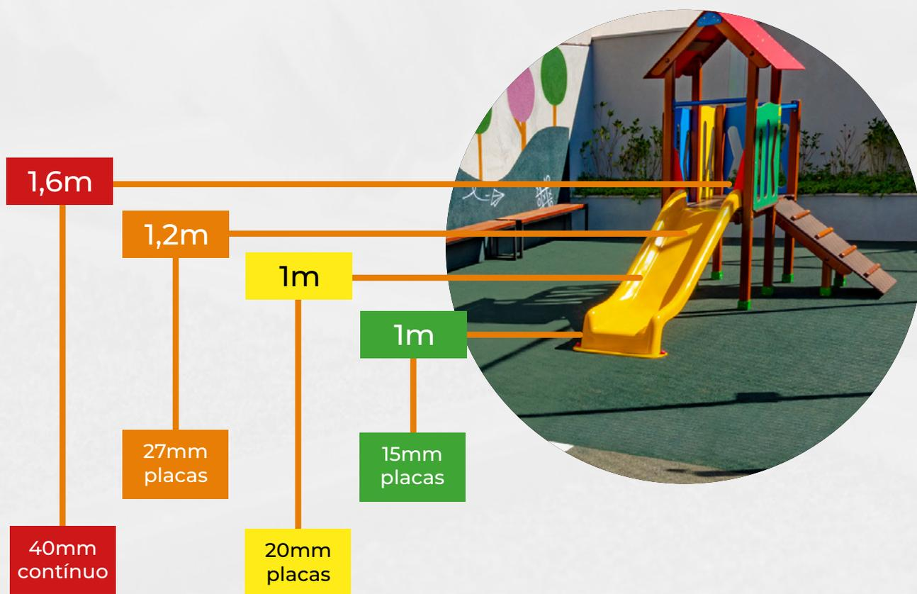
Laudo de Absorção de Impacto em conformidade com a NBR 16.071-3
